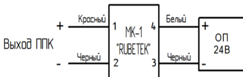
Рисунок 12 – Схема подключения МК-1 к ОП
